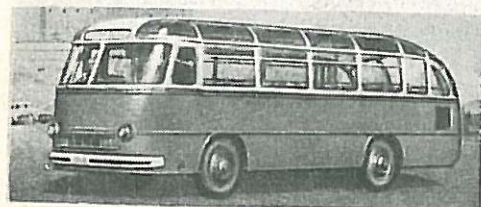
LA3-697 (1959—1963 гг.). Туристский автобус с несущим сварным кузовом, задним расположением двигателя. Мощность двигателя — 109 л. с. (80 кВт). Длина машины — 9,2 м. Число мест для сидения — 33. Масса в снаряженном состоянии — 7,3 т. Скорость — 80 км/ч.
