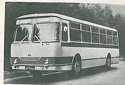
ЛиАЗ-677 (с 1967 г.). Городской автобус с автоматической трансмиссией, пневматической подвеской колес, передним расположением двигателя и сварным несущим кузовом. Мощность двигателя — 180 л. с. (133 кВт). Длина машины — 10,45 м. Число мест для сидения — 25, общее — 110. Масса в снаряженном состоянии — 8,38 т. Скорость — 70 км/ч.
