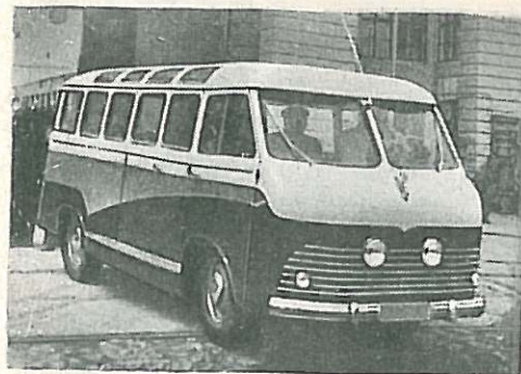
РАФ-10 (1957 г.). Первый отечественный микроавтобус. В машине использованы узлы и агрегаты легкового автомобиля «Победа». Мощность двигателя — 52 л. с. (38 кВт). Длина машины — 4,9 м. Число мест для сидения — 11. Масса в снаряженном состоянии — 1,64 т. Скорость — 80 км/ч.
