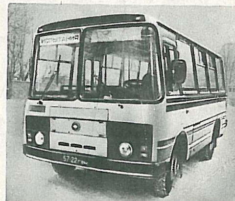
LA3-4202 (с 1981 г.). Городской автобус с автоматической трансмиссией и расположенным сзади дизельным двигателем КамАЗ. Мощность двигателя — 180 л. с. (133 кВт). Длина машины — 9,7 м. Число мест для сидения — 25, общее — 95. Масса в снаряженном состоянии — 8,6 т. Скорость — 77 км/ч.
