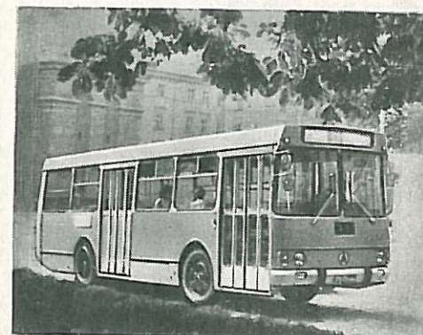
LA3-4202 (с 1981 г.). Городской автобус с автоматической трансмиссией и расположенным сзади дизельным двигателем КамАЗ. Мощность двигателя — 180 л. с. (133 кВт). Длина машины — 9,7 м. Число мест для сидения — 25, общее — 95. Масса в снаряженном состоянии — 8,6 т. Скорость — 77 км/ч.
