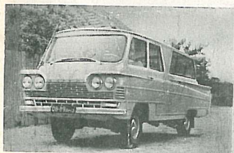
«СТАРТ» (1965 г.). Микроавтобус с кузовом из стеклопластика, выпущенный небольшой промышленной партией. Машина базировалась на агрегатах ГАЗ-21. Мощность двигателя — 70 л. с. (52 кВт). Длина машины — 3,5 м. Число мест для сидения — 12. Масса в снаряженном состоянии — 1,32 т. Скорость — 100 км/ч.
