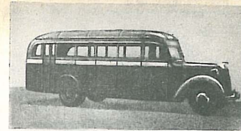
ЗИС-16 (1938—1941 гг.). Автобус для крупных городов, построенный на базе агрегатов и узлов грузового автомобиля. Мощность двигателя — 85 л. с. (63 кВт). Длина машины — 8,49 м. Число мест для сидения — 27, общее — 34. Масса в снаряженном состоянии — 5,1 т. Скорость — 65 км/ч.
