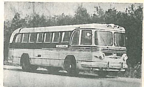
ЗИС-127 (1956—1960 гг.). Первый советский автобус для междугородного сообщения. Особенности конструкции: заднее расположение силового агрегата, дизельный двигатель, клепаный несущий кузов, гидросилитель руля. Мощность двигателя — 180 л. с. (133 кВт). Длина машины — 10,2 м. Число мест для сидения — 32. Масса в снаряженном состоянии — 10 т. Скорость — 95 км/ч.
