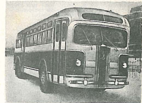
ЗИС-16 (1938—1941 гг.). Автобус для крупных городов, построенный на базе агрегатов и узлов грузового автомобиля. Мощность двигателя — 85 л. с. (63 кВт). Длина машины — 8,49 м. Число мест для сидения — 27, общее — 34. Масса в снаряженном состоянии — 5,1 т. Скорость — 65 км/ч.
