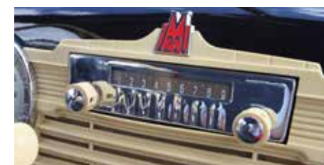
Все Победы, кроме таксомоторов, оснащались радиоприёмником – ламповым, естественно. В машинах такси на его месте был таксометр.
