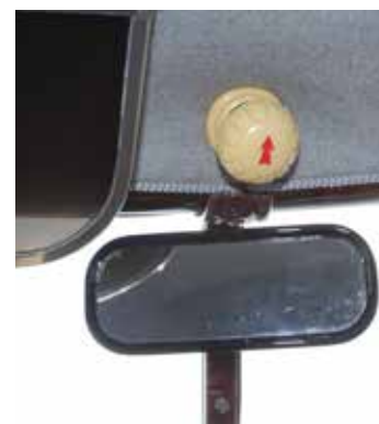
Салонное зеркало – размером с пудреницу, и видно в него немного через узенькое заднее окошко. А наружных зеркал на Победе не было! Сверху – рукоятка антенны радиоприёмника: стрелочка указывает, в каком она положении.
