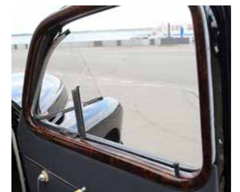
Боковые окна опускаются вместе с направляющими стойками. А рамки окладов пришлось делать из дорогой канадской древесины: в оригинале они были металлическими, но сегодня невозможно повторить технологию их окраски под дерево!
