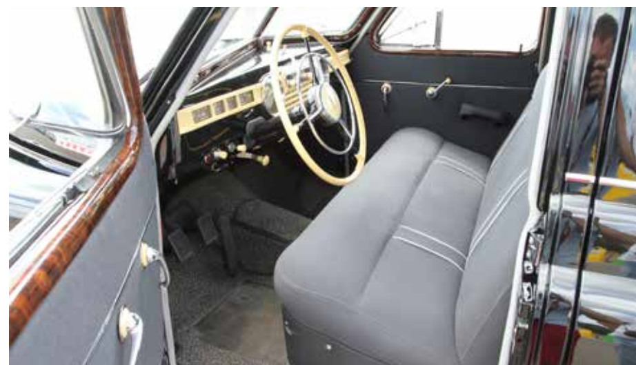
У сдвоенного переднего сиденья только одна регулировка – продольная. У гражданских Побед к 1956 году повсюду применяли дерматиновые обивки, но на ГАЗ-М20Г – отделка из качественной ткани, такой же, как в ЗИМе.
