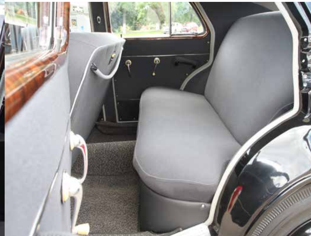
Салонное зеркало – размером с пудреницу, и видно в него немного через узенькое заднее окошко. А наружных зеркал на Победе не было! Сверху – рукоятка антенны радиоприёмника: стрелочка указывает, в каком она положении.
